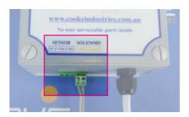
INSERT THE SOLENOID PLUG INTO THE CORRECT PORT ON THE CONTROL BOX AS INDICATED ON THE LABEL.
